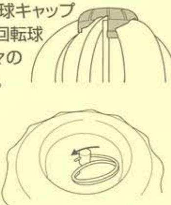
4 ③リングを軸の上部の横穴に差し込んで固定して下さい。
